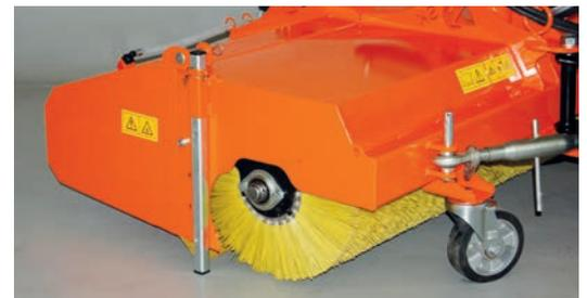
Schmutzsammelbehälter, abgedeckte Hauptbürste, Laufrad
